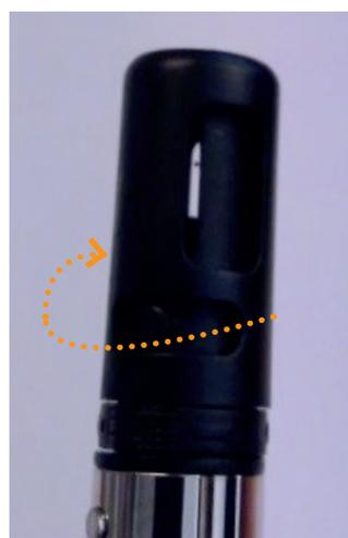
Les capteurs de vent et de température sont couverts par une protection. Il est donc nécessaire d'ouvrir cette protection pour effectuer une mesure. Pour cela, il suffit de saisir le haut de l'embout et de le tourner dans le sens des aiguilles d'une montre.
